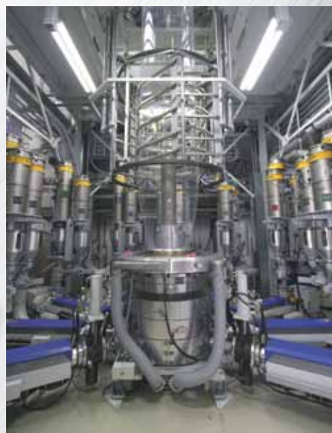
Urządzenie do produkcji wielowarstwowych, wysokobarierywnych folii tworzywowych
